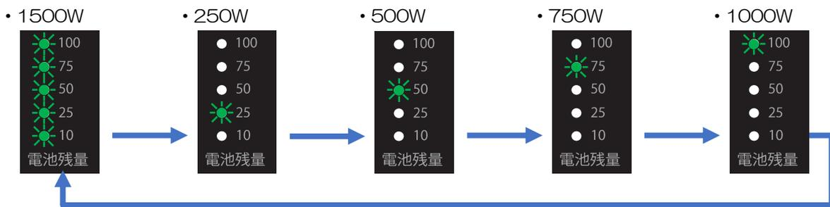
4. 設定したい充電入力電力に表示を変更し、表示が消灯したことを確認する。
